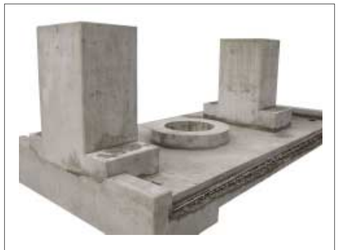
Bild 1 und 2. Plattenförmiger Träger für eine Papiermaschine. Allplan liefert einen automatisch eingeschalteten Betonkörper Figs. 1 and 2. Board type supports for a paper machine. Allplan automatically gives the shuttered concrete bodies
